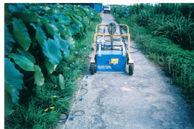
浅層反射法弾性波探査測定状況
